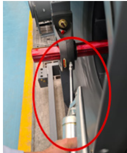
2.- Con ayuda de una pistola manual engrasadora inyecte la grasa de acuerdo con la especificación del proveedor
